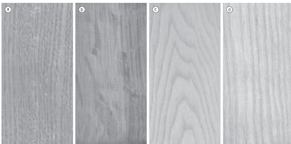
Slika 8. Makroskopski prikaz drva hrasta lužnjaka/kitnjaka: a) tangentski i b) radijalni presjek, i drva običnoga jasena: c) tangentski (izvor: Richter i Dallwitz 2000) i d) radijalni presjek
