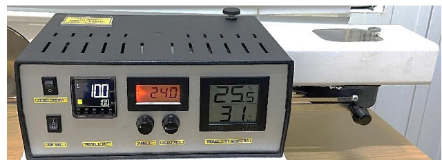
Sl.8 Uređaj za nedestruktivno mjerenje otpora prolazu topline, propusnost vodene pare i otpora prolazu vodene pare, tzv. Permetest
