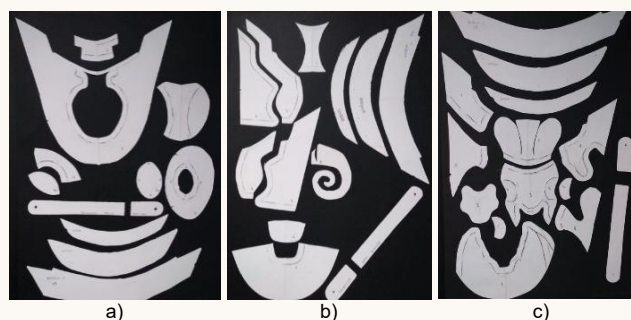
Slika 6. Šablone za krojenje za: a) prototip 1, b) prototip 2, c) prototip 3 [9]
