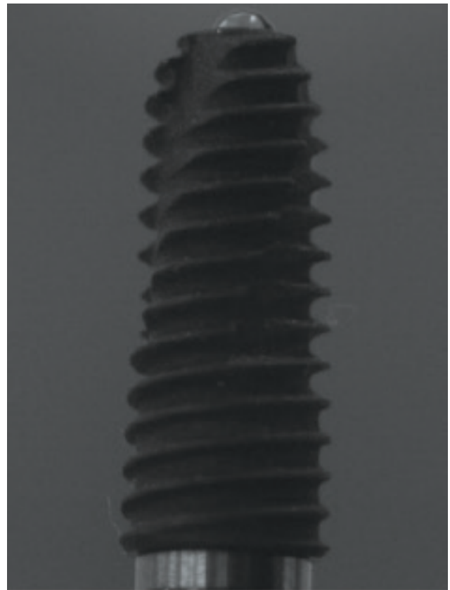
Slika 3. Prikaz kapljice na površini implantata tokom mjerenja kontaknog kuta. Slika je u vlasništvu autora.
