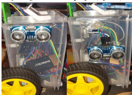
Slika 12. Razlika u položaju lijevoga senzora prije (lijevo) i nakon (desno) podešavanja.
