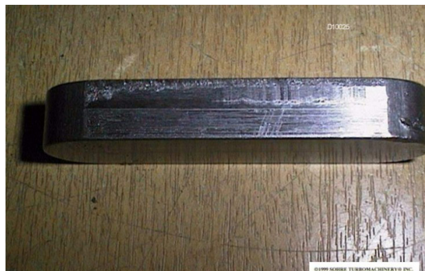
Slika 7. Jamičavost uložnog pera [4] Figure 7. Pitting of the insert pen [4]
