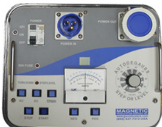
Slika 17. Uređaj za demagnetizaciju [5] Figure 17. Demagnetization device [5]
