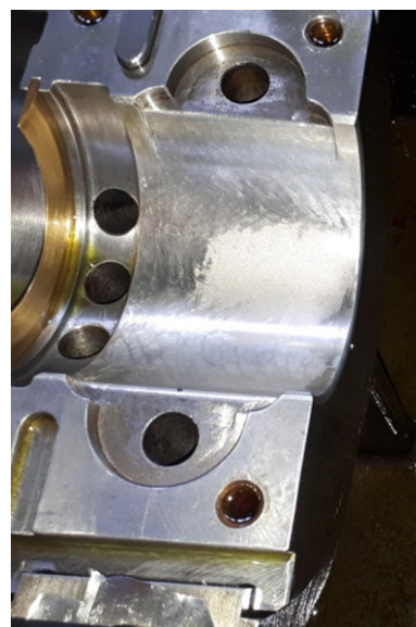
Slika 4. Matirani sloj na donjoj polovici nosivog ležaja Figure 4. Matte layer on the lower half of the bearing
