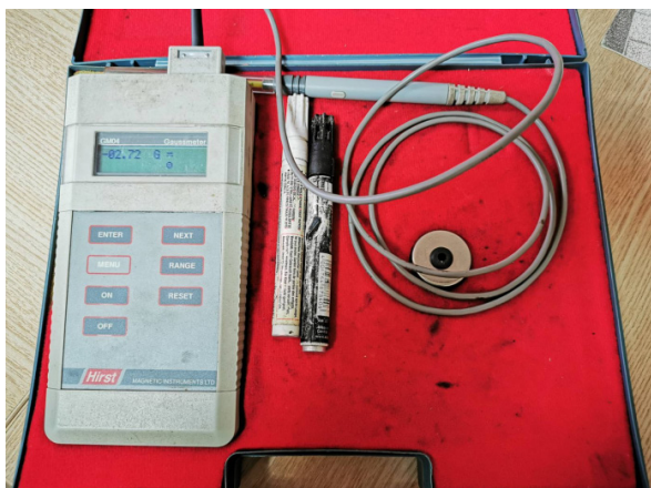
Slika 9. Digitalni gaussmetar [5] Figure 9. Digital gauss meter [5]
