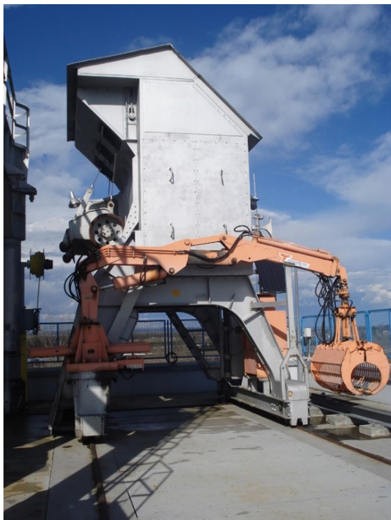
Slika 17. Čistilica s košarom na sajle i hidrauličkom dizalicom Figure 17. Cleaner with basket on cables and hydraulic crane
