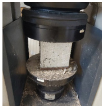
Slika 5. Ispitivanje tlačne čvrstoće betona Figure 5 Test of compressive strength of concrete
