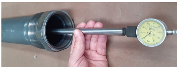
Slika 3. Mjerenje unutarnjeg promjera cilindra hidraulične kočnice
