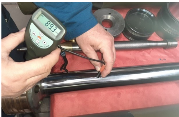
Slika 7. Mjerenje debljine tvrdo kromirane prevlake Figure 7 Hard-chrome plating thickness measurement
