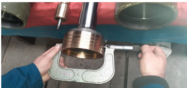
Slika 5. Mjerenje vanjskog promjera košuljice Figure 5 Measuring the outside diameter of a lining
