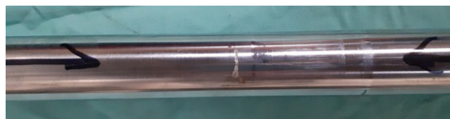
Slika 8. Oštećenje tvrdo kromirane prevlake klipnjače Figure 8 Piston rod hard-chrome plating damage
