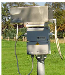
Figure 7 Precipitation detector, Eigenbrodt RS 85 (Eigenbrodt 2024)
