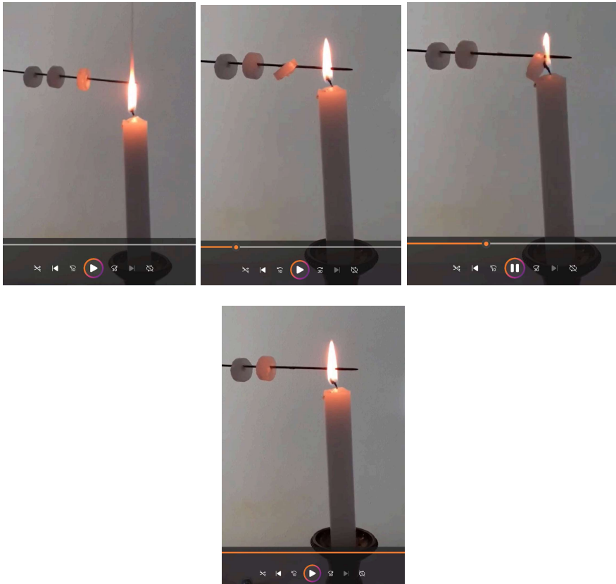
Slika 1: Zagrijavanjem tankog metalnog štapa toplina se prenosi iz područja više u područje niže temperature. Dokaz toga u ovom pokusu su kolotovi voska koji se postepeno tope.
