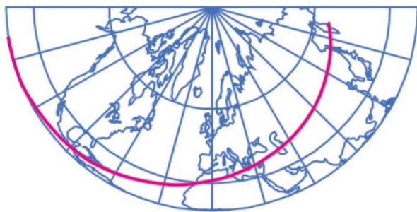
Slika 8. Karta sjeverne hemisfere u uspravnoj konusnoj projekciji ekvidistantnoj uduž paralela uz n = 0.5 . Krivulja koja povezuje točke s koordinatama \varphi_1 = 0^\circ 00' \text{ S} , \lambda_1 = 165^\circ 00' \text{ W} i \varphi_2 = 55^\circ 00' \text{ N} , \lambda_2 = 165^\circ 00' \text{ E} slika je loksodrome u toj projekciji.
