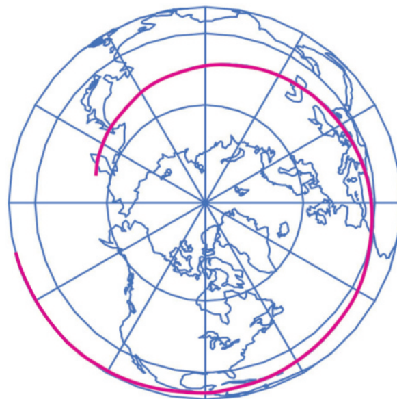
Slika 8. Karta sjeverne hemisfere u uspravnoj konusnoj projekciji ekvidistantnoj uduž paralela uz n = 0.5 . Krivulja koja povezuje točke s koordinatama \varphi_1 = 0^\circ 00' \text{ S} , \lambda_1 = 165^\circ 00' \text{ W} i \varphi_2 = 55^\circ 00' \text{ N} , \lambda_2 = 165^\circ 00' \text{ E} slika je loksodrome u toj projekciji.
