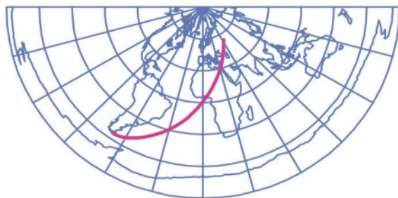
Slika 6. Karta svijeta u uspravnoj konusnoj projekciji ekvidistantnoj uzduž meridijana uz n = 0.5 . Krivulja koja spaja točke s koordinatama \varphi_1 = 55^\circ 00' \text{ S} , \lambda_1 = 65^\circ 00' \text{ W} i \varphi_2 = 55^\circ 00' \text{ N} , \lambda_2 = 65^\circ 00' \text{ E} slika je loksodrome u toj projekciji.
