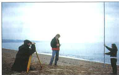
Sl. 5. Rad na terenu pomoću nivelira (prikupljanje podataka za određivanje presjeka plaže)
