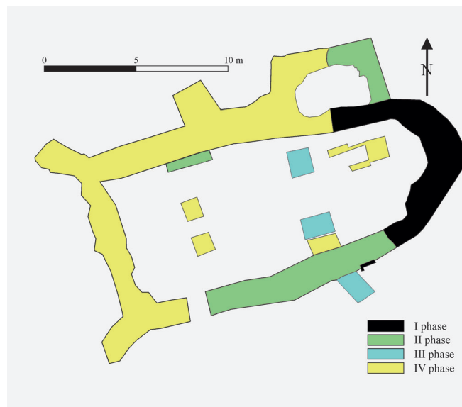
Sl. 6. Tlocrt crkve s fazama izgradnje
