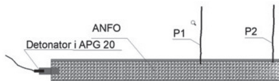
Slika 2. Postav mjerenja brzine detonacije Figure 2. Velocity of detonation measurement setup
