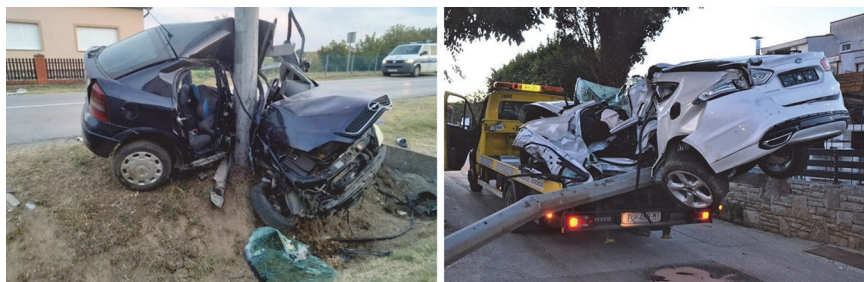
Slika 2. Posljedice udara vozila u uobičajene krute stupove uz ceste [6, 8]
