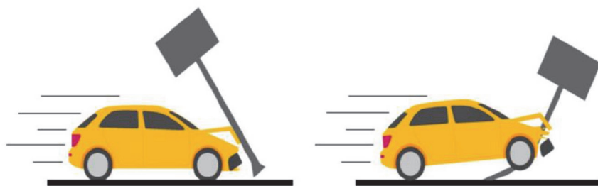
Slika 7. Shematski prikazi otkazivanja stupova s odvajanjem (SE) i bez odvajanja (NS) [24]
