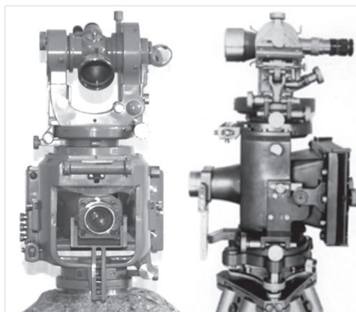
Slika 3. Wildovi fototeodoliti P30 (lijevo) i FT9 (desno) [20].
