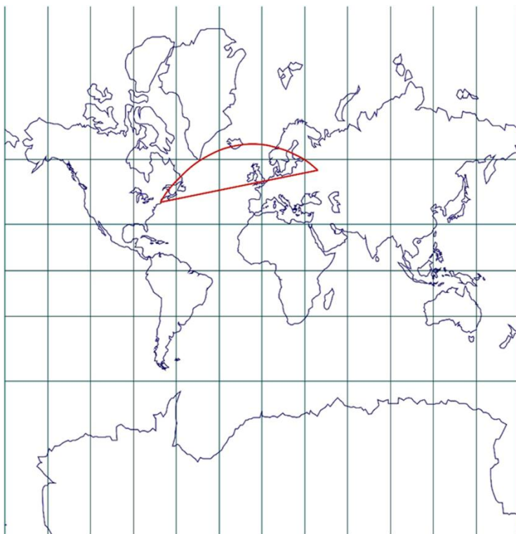
Slika 2. Karta svijeta u uspravnoj Mercatorovoj projekciji. Ravna crta koja spaja New York i Moskvu je slika loksodrome, a krivulja koja spaja ta dva mjesta slika je geodetske linije. Geodetska linija daje najkraću udaljenost između dvaju mjesta na elipsoidu, pa se slika 2 može interpretirati kao iluzija, a zapravo je riječ o distorziji zbog kartografske projekcije.
