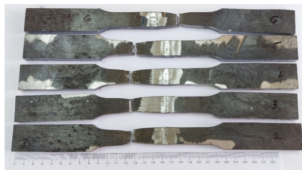
Slika 6 Ispitne epruvete nakon statičkog vlačnog ispitivanja Figure 6 Test specimens after static tensile testing
