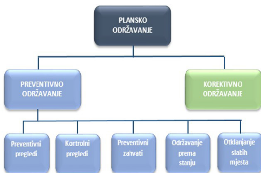
Slika 6. Plansko održavanja skijaških žičara na skijalištu Sljeme [3]
