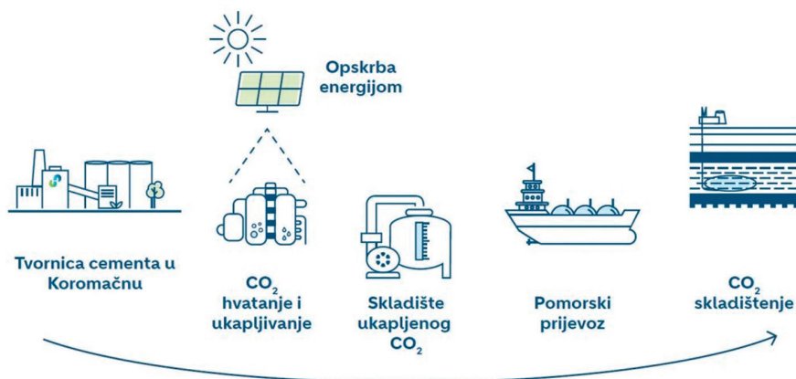
Slika 6. Shematski prikaz hvatanja ugljika u tvornici u Koromačnu (Holcim, 2025.).
