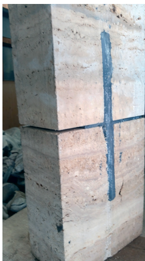
Slika 11. Probni uzorci travertina – nalijevanje inoks-sidara olovom. Kameni elementi ispitani su na IGH 2 i pokazali su zadovoljavajuće rezultate na izvlačenje sidara, a druga se ispitivanja u to vrijeme nisu obavljala
