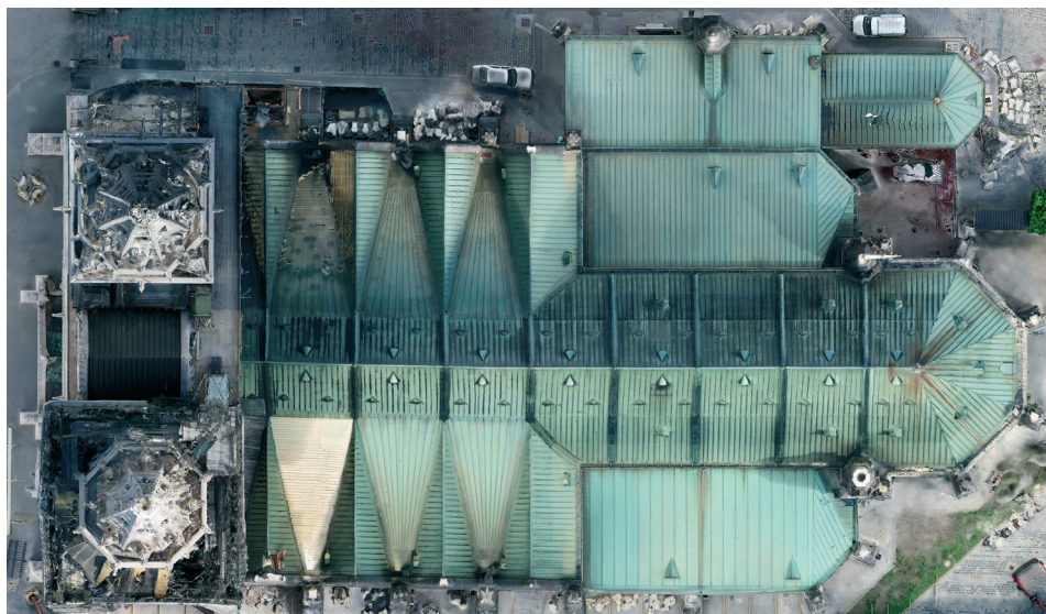
Slika 23. Katedrala, tlocrt krova – fotogrametrija (izradio Geodetski fakultet u Zagrebu)
