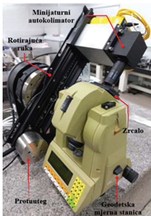
Slika 9. Prikaz postupka umjeravanja geodetske mjerne stanice Leica TC2003 (prema Kim i dr. 2024).
