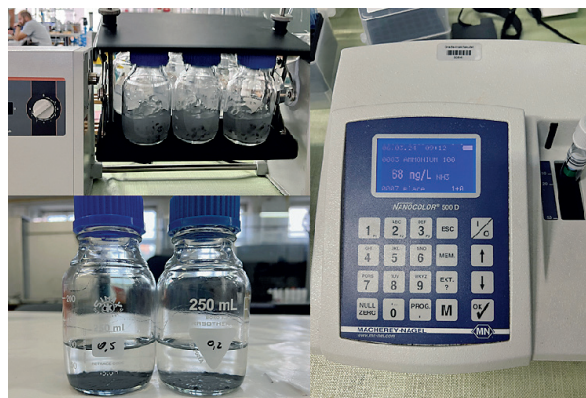
Slika 3: Tijek odvijanja eksperimenata adsorpcije s prikazom dijela korištenog instrumentarija
