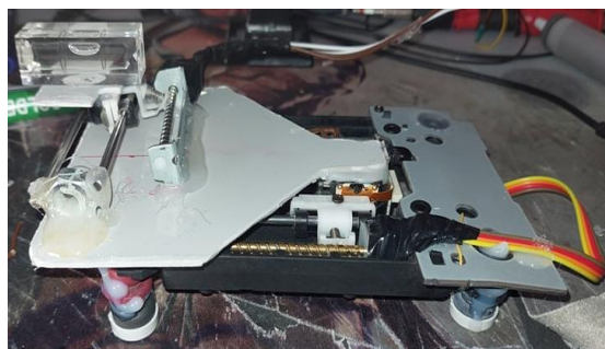
Slika 10. Provjera vodoravnog položaja platforme.
