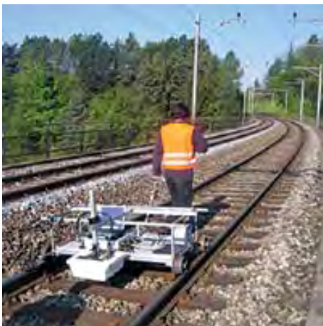
Slika 5. Višekanalni georadarski sustav instaliran na posebna kolica [19]
