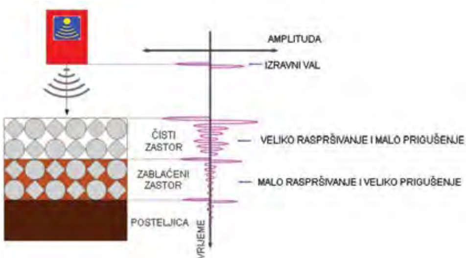
Slika 4. Ponašanje elektromagnetnog signala pri nailasku na zastorni materijal različite kvalitete [16]
