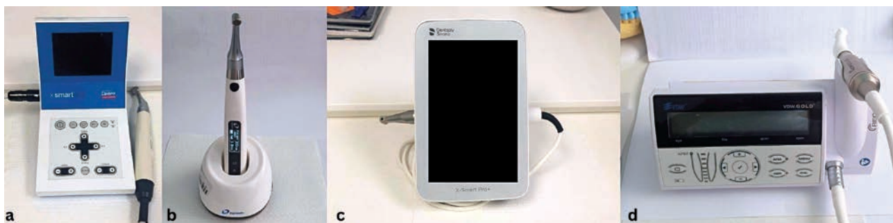
Slika 2. Različiti tipovi endomotora koji podržavaju rotacijsku i recipročnu kretnju. a. X-Smart Plus (Dentsply Maillefer, Tulsa, OK, SAD), b. E-Connect S (Eighteeth, Changzhou, Kina), c. X-Smart Pro Plus (Dentsply, Charlotte, NC, SAD), d. VDW Gold Reciproc (VDW, München, Njemačka)
