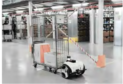
Slika 10. RoboSavvy s mapiranjem, navigacijom, izbjegavanjem prepreka i izbjegavanjem rizika na razini poduzeća (Izvor: https://www.robotics247.com/ )
