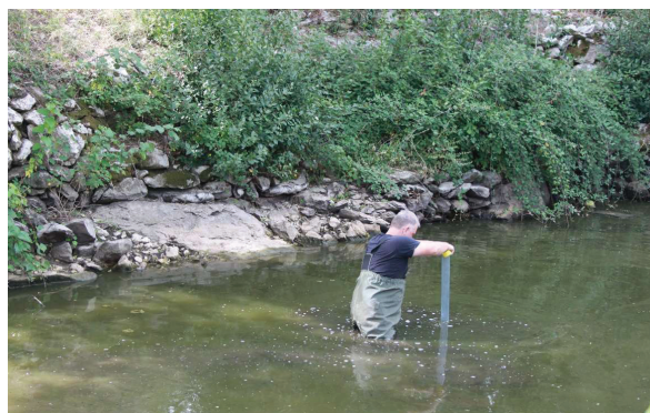
Slika 8: Uzorkovanje neporemećenog slijeda sedimenta utiskivanjem (izvor HGI)
