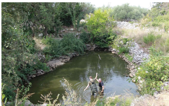
Slika 7: Primjer ispitivanja debljine vode i sedimenata pomoću metalnih šipki u lokvi Prljevići (izvor HGI)
