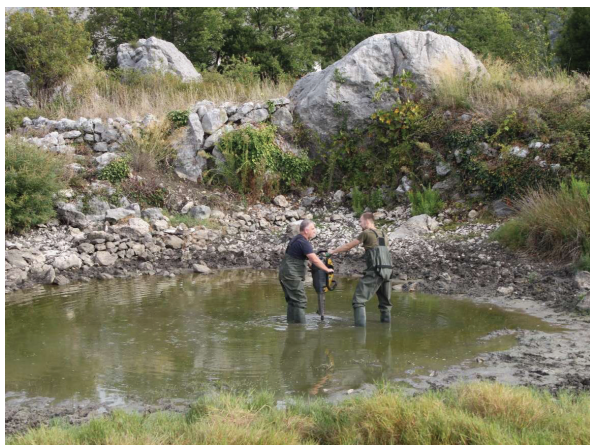
Slika 12: Uzorkovanje pomoću udarne bušilice Eijkelkamp Cobra u lokvi u Majkovima (izvor HGI)
