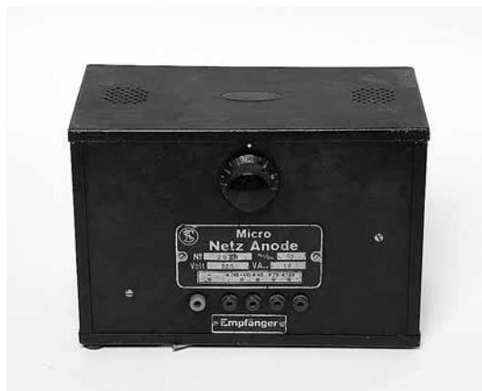
sl.6. Mrežni ispravljač za punjenje anodnih baterija što ga je osmislio Josip Slišković, TMNT 11210, Radijska i televizijska tehnika. Fotografirao G. Martinović.
