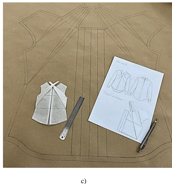
Sl.10 Modeliranje temeljnog kroja prema skici Modela 3: a) prilagodba temeljnog kroja prednjeg i stražnjeg dijela bluze b) prilagodba temeljnog kroja rukava, c) modeliranje zadanog modela bluze u omjeru 1:5 i 1:1
