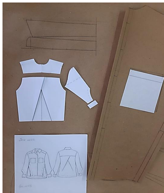
Sl.6 Modeliranje temeljnog kroja prema skici Modela 1: a) prilagodba temeljnog kroja prednjeg i stražnjeg dijela bluže, b) prilagodba temeljnog kroja rukava, c) modeliranje zadanog modela bluže u omjeru 1:5 i 1:1
