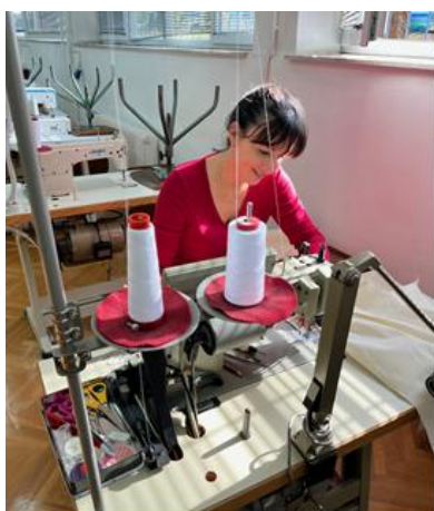
Sl.11 Izrada modela ženskih bluzi u Tehnološkom laboratoriju za procese odjevnih tehnologija: a) modeliranje ženske bluze na krojačkom papiru, b) spajanje krojnih dijelova na univerzalnom šivaćem stroju JUKI DDL-5550-4, c) Model 3 ženske bluze odjeven na krojačku lutku, bez ušivenih rukava, d) Model 1 ženske bluze nakon postupka međufaznog glačanja
