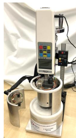
SI.6 Višenamjenski diferencijalni konduktometar
