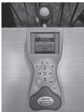
Slika 3. Prikaz uređaja za mjerenje osvjetljenja prostora Figure 3. Display of a device for measuring room illumination
