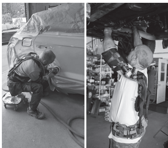
Slika 6. Uporaba egzoskeleta kod bojenja i popravka vozila
