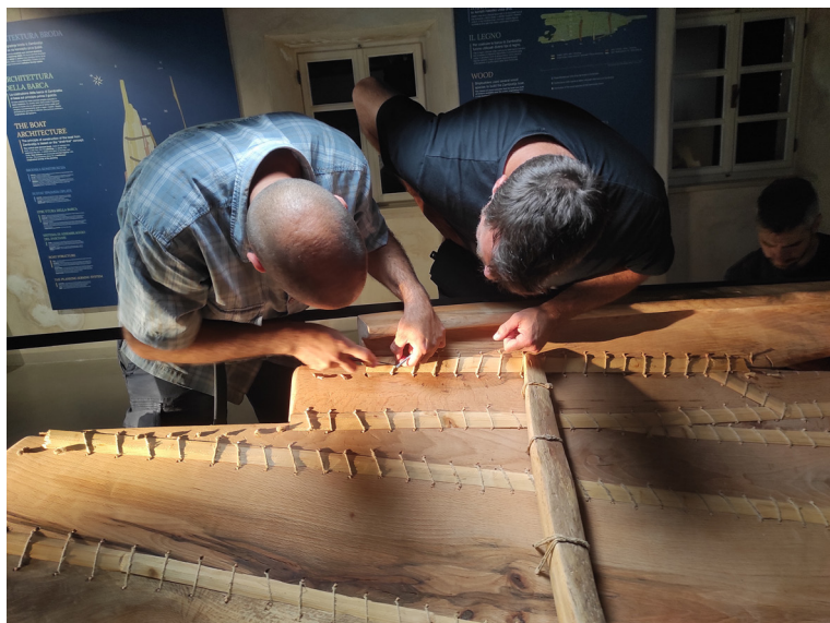
Slika 4. Replika broda Zambratija – uzdužno šivanje oplata
