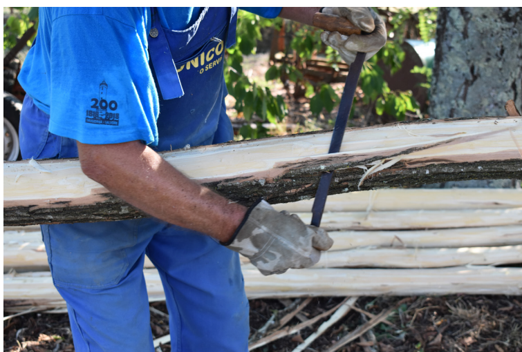
Slika 2. Ako se stablo bagrema siječe u „pravoj luni“, za puna mjeseca krajem kolovoza, drveni stupovi su dugotrajni. Važno je i odmah po sječi oguliti koru s trupaca, koja se najbolje skida ručnim strugačem kore (spiana a due man).
