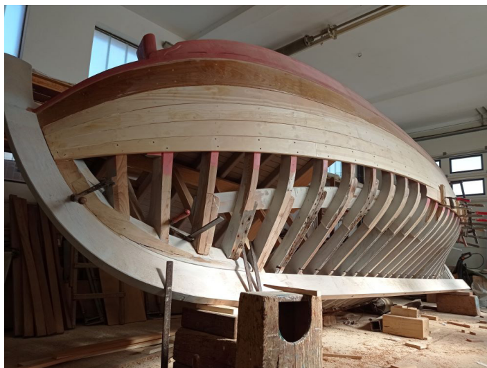
Slika 5. Obnova betinske gajete Jaka
