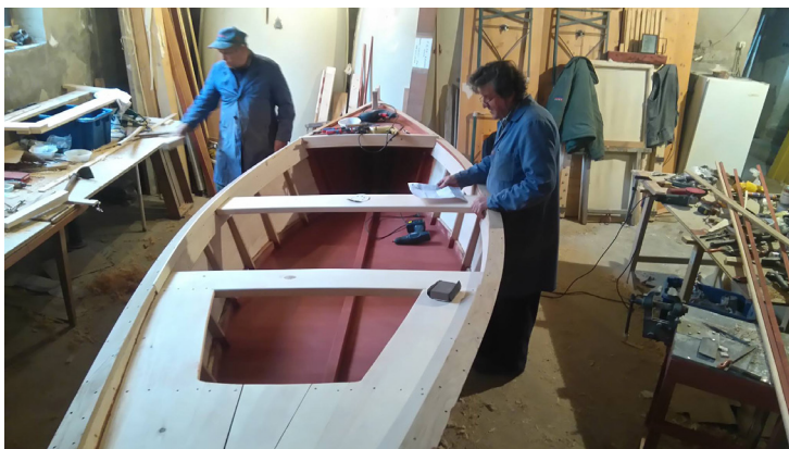
Slika 5. Gradnja komiške sandule
