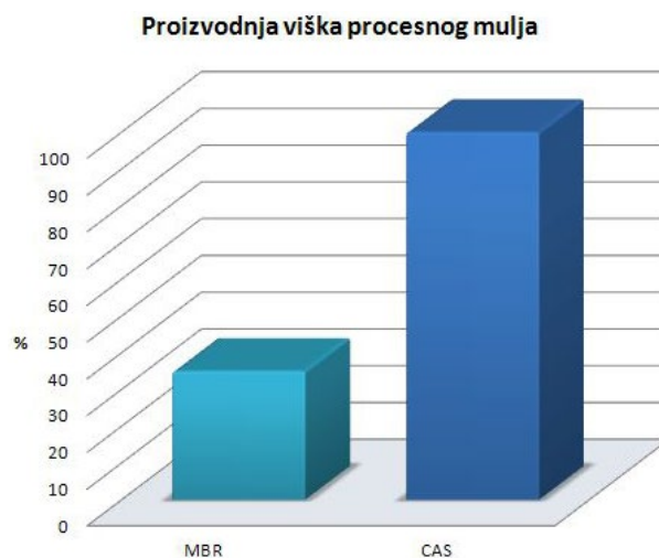
Slika 10. Grafički dijagram razlike između MBR-a i konvencionalnih sustava u obradi mulja
