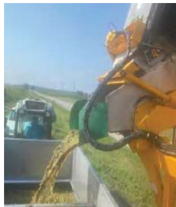
Slika 5. Pražnjenje spremnika za grožđe (Izvor: Bošnjak, 2022.)
