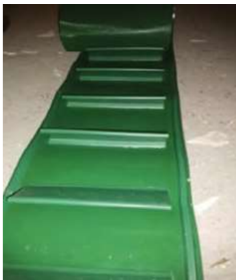
Slika 4. Nemontirana transportna traka (Izvor: Bošnjak, 2022.)
