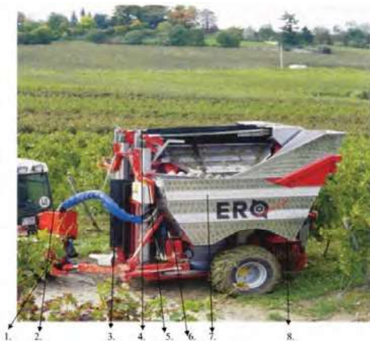
Slika 8. Vučeni kombajn ERO 1. Prikvačno trotočje, 2. Hidraulički razvodnik, 3. Vodilica, 4. Traka, 5. Elektronska upravljačka jedinica, 6. Hidraulični pogon tresaća, 7. Spremnik za grožđe, 8. Grablje (Izvor: ERO, priručnik za rukovanje i održavanje)
