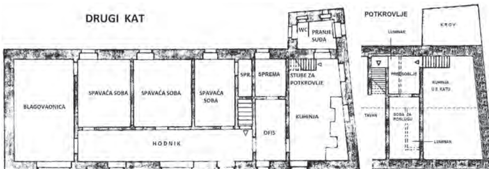
Tlocrt II. kata prije 1869. (lijevo) Prema nacrtu postojećeg stanja koji je izradio Vicko Kovačević iz Hvara, a precrtao u Mostaru 1925. J. S. Ugojlkov, aneks na sjeveroistočnom uglu palače izgrađen je poslije 12. 8. 1524., nakon što je izgrađen zahod na zimskoj palači Paladinić. Stubištem iz kuhinje se ulazilo u prostoriju iznad spremišta, a iz nje u sobu za posluđu iznad radne sobe. Iz prostora iznad drugog spremišta išlo se stubištem na tavan u kojem su, po mojoj pretpostavci, također mogli biti prostori za posluđu. Na krovu su se sigurno nalazili luminari. Crtao Ivo Štambuk, d.i.a.
