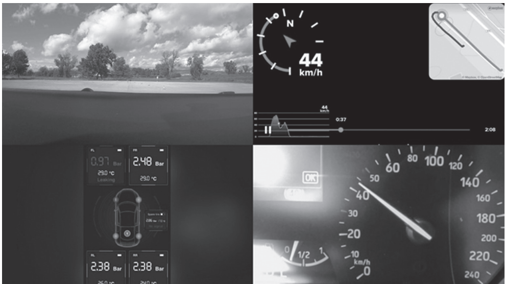
Slika 16: Prikaz pozicije vozila na testnoj putanji, brzine kretanja i tlaka zrak u pneumaticima
