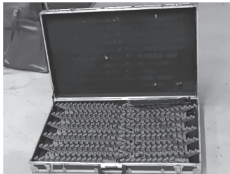
Slike 1, 2: Uređaj za prisilno zaustavljanje motornih vozila
