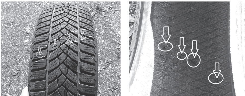
Slike 7, 8: Prikaz vanjske i unutarnje strane pneumatika nakon prelaska preko uređaja
