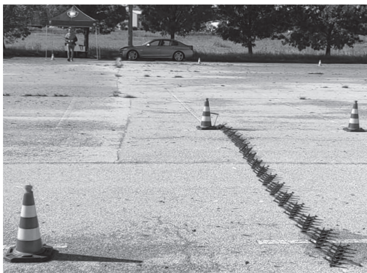
Slika 3: Prikaz uređaja za prisilno zaustavljanje motornog vozila koji je spreman za uporabu
