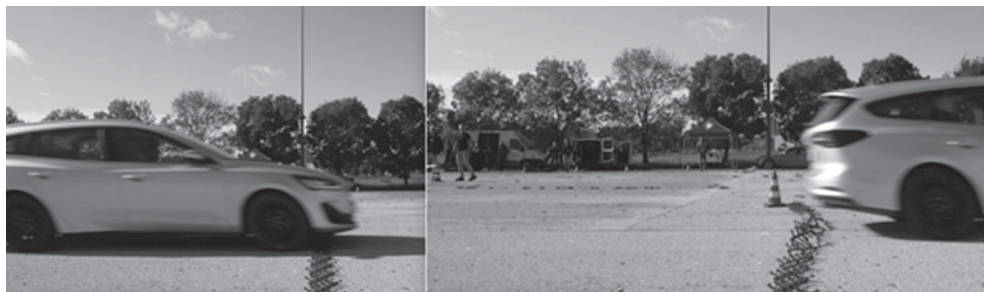
Slika 4: Prikaz prelaska vozila preko uređaja za prisilno zaustavljanje motornog vozila
