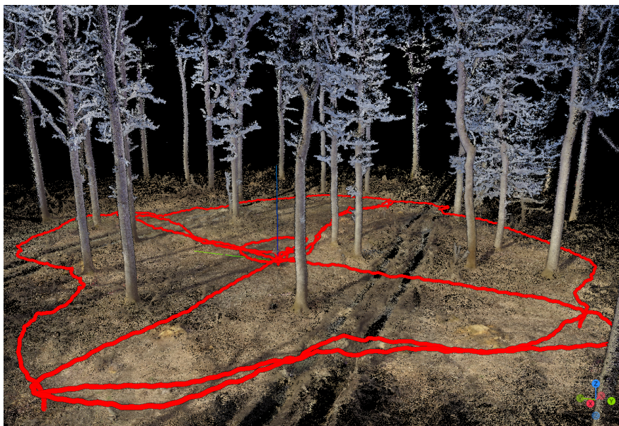
Slika 4. Prikaz georeferenciranog oblaka točaka i provedene sheme skeniranja (crvena linija) u FARO Connect softveru na primjeru jedne plohe.
