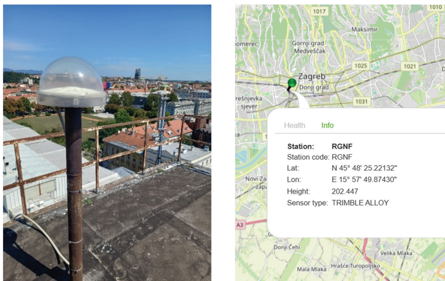
Slika 3. Lijevo: točka RGNF s GNSS antenom Zephyr Geodetic 3 i zaštitnom kupolom; desno: elipsoidne koordinate (GRS80) točke RGNF (URL 15).
