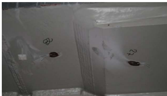
Slika 29. - Mjerne trake za mjerenje deformacija za promjenu debljine lamela
