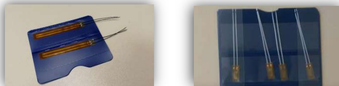
Slika 10. - Mjerne trake za beton (lijevo) i čelik (desno)
