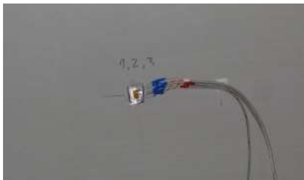
Slika 22. - Mjerne trake za mjerenje deformacija uz opornjak U2
