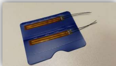
Slika 10. - Mjerne trake za beton
