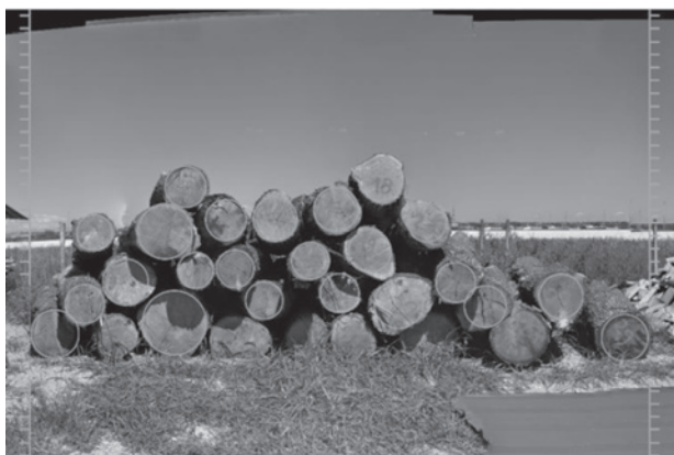
Slika 2. Primjer izmjerena složaja mobilnom aplikacijom iFovea Fig. 2 Example of a measured stack by iFovea mobile application
