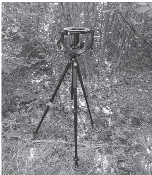
Slika 3. Stalak, fotoaparat i riblje oko »fisheye« za snimanje hemisfernih fotografija (snimio: K. Popić)
