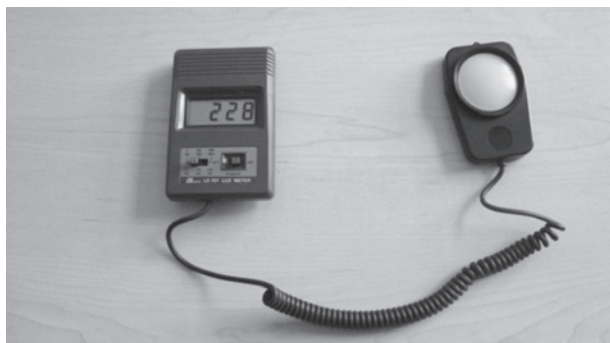
Slika 1. Instrument za mjerenje osvjetljenja (lx) (snimio: D. Ugarković)
