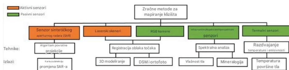
Slika 8. Sustavi koji se koriste za kartiranje klizišta prema tipovima senzora, mogućim tehnikama obrade i dostupnim rezultatima (Hussain i dr. 2022).
