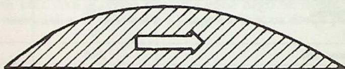
Slika 3. Presjek krila broda "Mirta"
