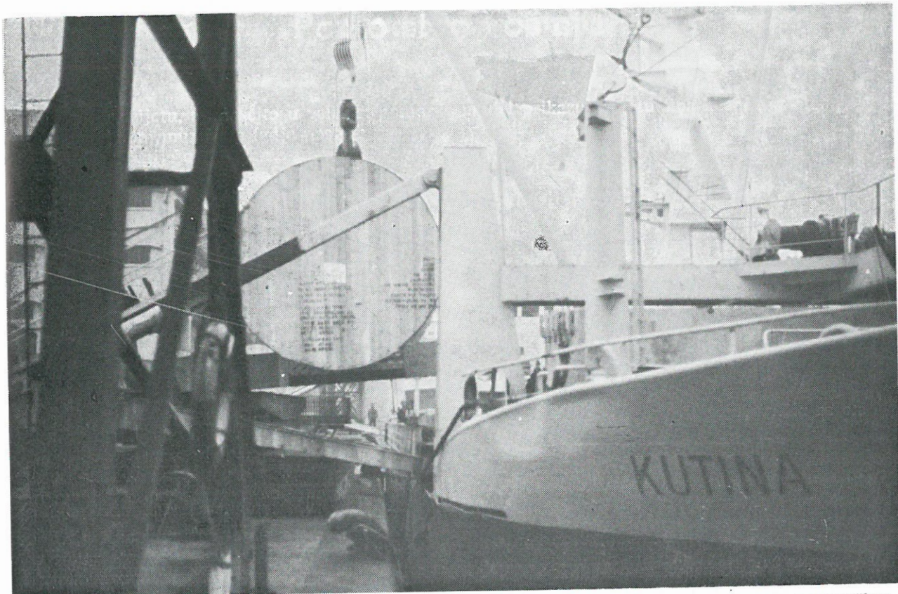
M/b »KUTINA«, specijalni brod za prijevoz teških tereta, ima samaricu kapaciteta 150 tona; utovar teškog koleta na palubu
